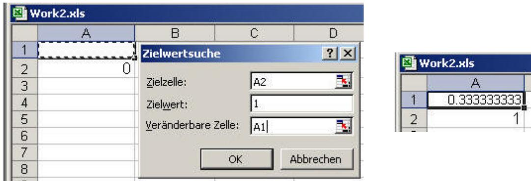
Ersetzen wir dann die Formel durch „=SIN(A1)\*EXP(A1)“, so wird jetzt mit denselben Eingaben wie oben in das Zielwertsuchfenster die veränderte Gleichung  $1 = \sin(x) \cdot e^x$
