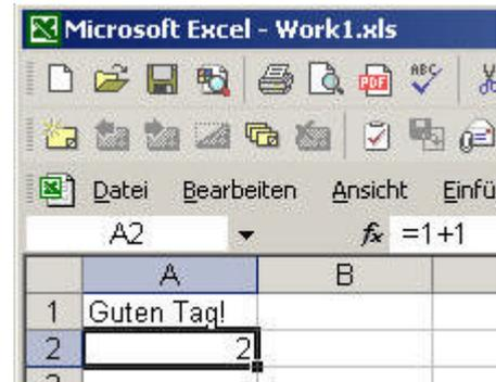
In eine Zelle kann man einen Text schreiben oder in ihr eine Rechnung ausführen. Nebenstehendes Bild zeigt, dass hier in A1 der Text „Guten Tag!“ geschrieben worden ist. Dadurch ist sie zu einem **Textfeld** geworden. In A2 wurde die Rechnung „1+1“ ausgeführt. Hier hat man jetzt ein **Zahlenfeld (berechnetes Feld)**.
