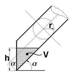
Ein rundes Rohr mit dem Radius r ist stirnseitig (links in nebenstehender Skizze) transparent durch ein Sichtglas verschlossen. Auf diesem Sichtglas soll eine Skala angebracht werden, auf welcher das jeweils im Rohr vorhandene Flüssigkeitsvolumen ablesbar ist.
