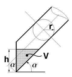
Ein rundes Rohr mit dem Radius r ist stirnseitig (links in nebenstehender Skizze) transparent durch ein Sichtglas verschlossen. Auf diesem Sichtglas soll eine Skala angebracht werden, auf welcher das jeweils im Rohr vorhandene Flüssigkeitsvolumen ablesbar ist.
