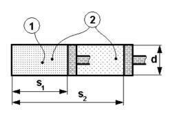
Im gezeigten Zylinder mit dem Kolben in den 2 Positionen (1) und (2) ist Stickstoff eingeschlossen. Der Innendurchmesser des Zylinders ist  $d = 5.0 \, cm$ , die Innenlänge in der Position (1) ist  $s_1 = 10.0 \, cm$ . In dieser Position herrscht ein Innendruck von  $1.0 \, bar$  und eine Temperatur von  $18.0^{\circ} \, C$ .
