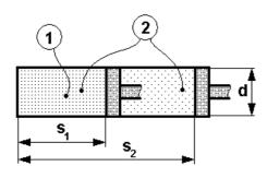
Dans le cylindre montré avec le piston dans les 2 positions (1) et (2) se trouve de l'azote. Le diamètre intérieur du cylindre est  $d = 5.0 \, cm$ , la longueur intérieure dans la position (1) est  $s_1 = 10.0 \, cm$ . Dans cette position il y a une pression intérieure de  $1.0 \, bar$  et une température de  $18.0^{o} \, C$ .
